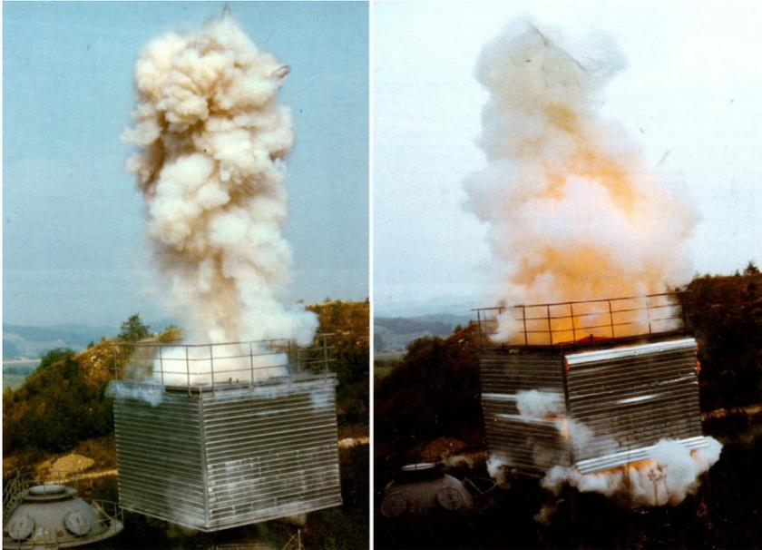
**Abb.3.363:** Löschpulveraustritt (links) und Flammenaustritt bei Nichtvorhandenseins einer Löschmittelsperre (rechts) unmittelbar nach dem Ansprechen der Entlastung des "Wetterschutzraumes"
