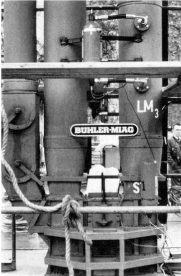
**Abb.3.371:** Verstärkter Elevatorfuss mit Löschmittelsperre (oben)
