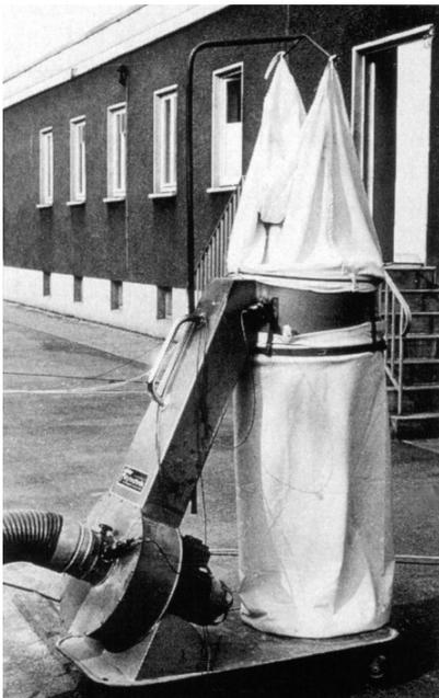
**Abb. 4.46:** Absauggerät der Holzverarbeitenden Industrie
