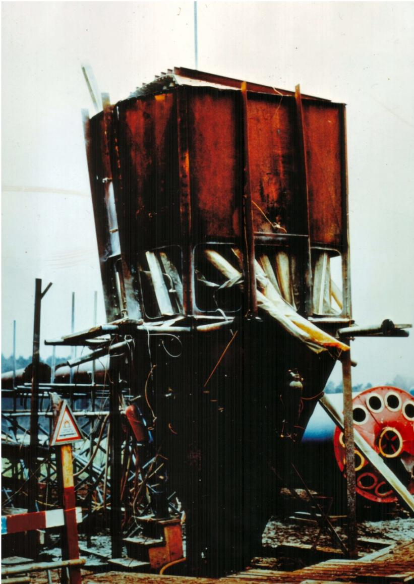
**Abb.4.45:** 13,6 m<sup>3</sup>-Schlauchfiltergehäuse mit Einbauten nach Explosionsunterdrückungsversuch mit Propan
