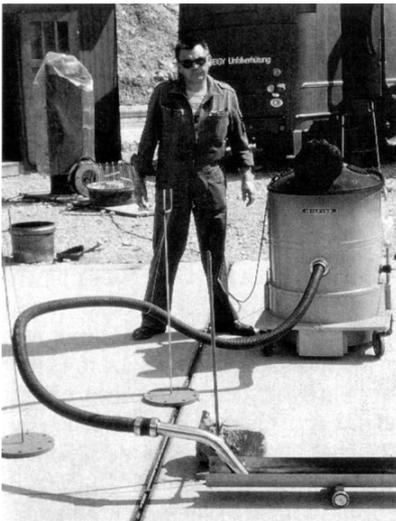
**Abb. 4.48:** 220l-Industriestaubsauger für Zündversuche vorbereitet
