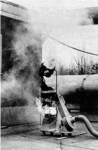
**Abb. 4.47:** Nachbrand im Absauggerät gemäss Abb. 4.46
