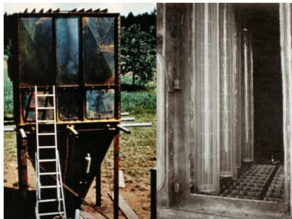
**Abb.4.36:**  $13,6 \text{ m}^3$ -Schlauchfiltergehäuse (a) und mit Plastikfolie überzogene Stützkörbe (b)
